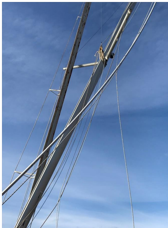
Beakta förstagsprofil och den stående riggen när masten firas ned.
