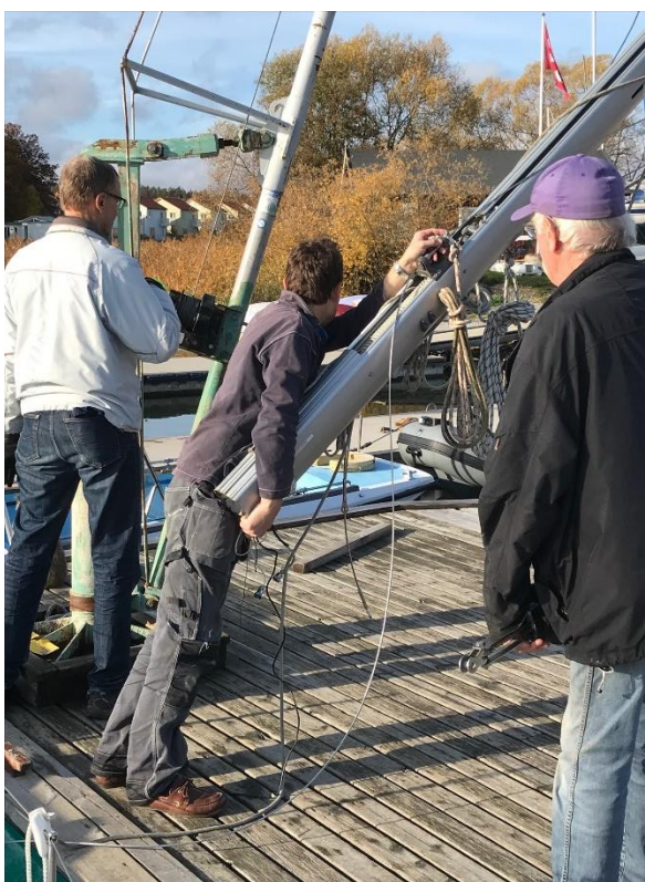
Fortfarande viktigt att hålla stadigt tag i roten på masten medan masten vrids in mot bryggan och stödbockarna. Medhjälpare assisterar med att sammanföra lösningen.
