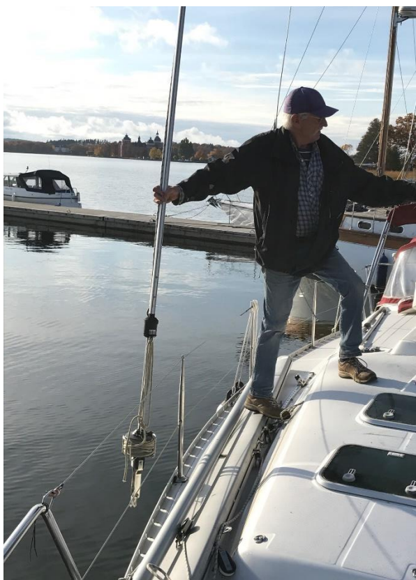
Be nu kranskötaren att försiktigt hissa masten lite så den släpper från mastfot, släppa bromsen och vrid saktast mastkranen in mot bryggan. Följ efter med förstagsprofil.
