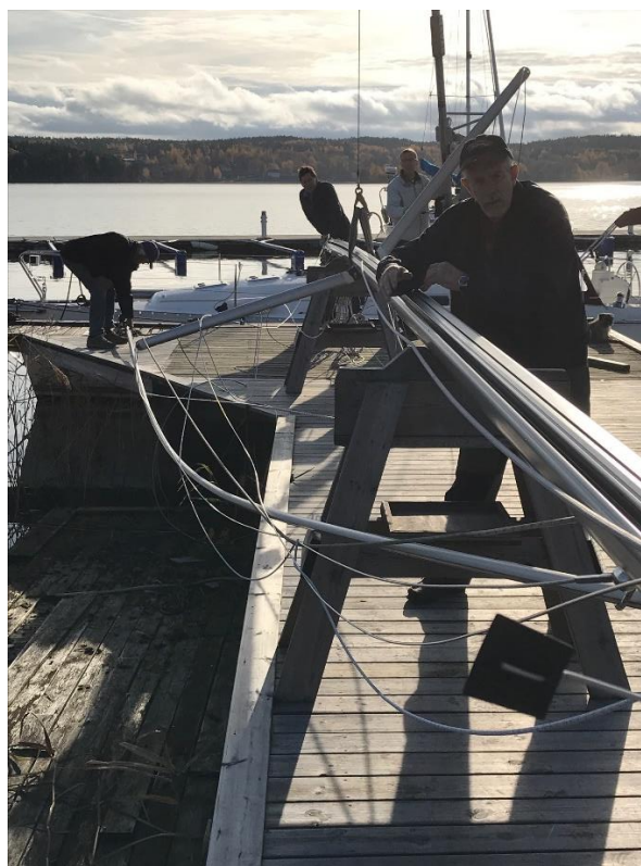
Masten är nu på säkrad på bryggan. Vid avmastning demontera utrustning som kan skadas under vinter, demontera/monter spridare och vant.
