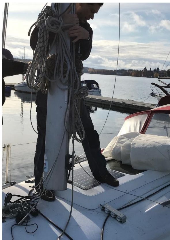
Medhjälparen som hållit masten följer nu lugnt med när kranen svängs. Släpp inte taget om masten ännu!
